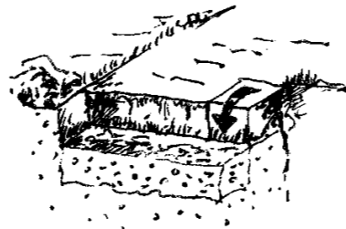
Recouvrir avec la terre végétale de la tranchée suivante
